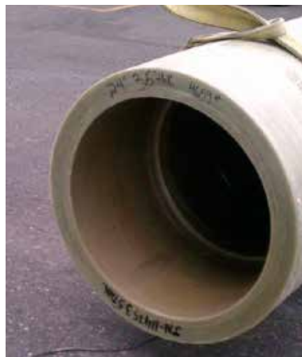
Rys. 2. High Strength Culvert – osłona wzmacniająca z włókna szklanego Źródło: Za zgodą Theater Lead FSR, Asymmetric Technologies Mr. Steve Cramer
